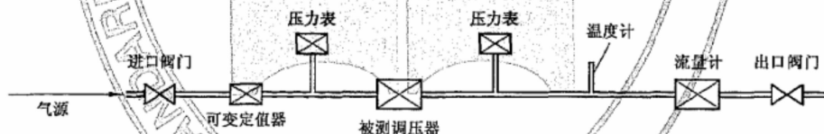
图 3 调压静特性试验装置系统
